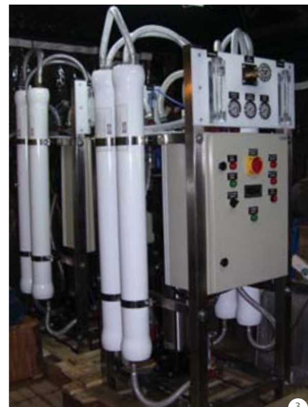
1- Sistema de filtración por carbón activado granular. General Motors. Rosario. Pcia. de Santa Fé. 2- Ingeniería, provisión, montaje y puesta en marcha de equipo de ósmosis inversa
